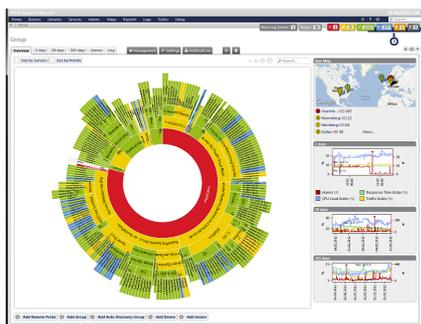
Abbildung: Der Sunburst View von PRTG bietet einen schnellen Überblick über den Zustand des Netzwerks.
